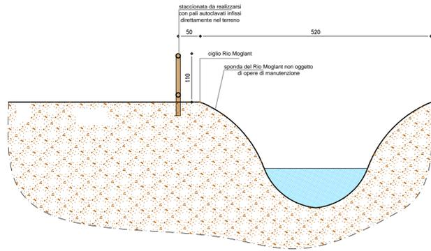
Sezione A - A della staccionata tipo da realizzarsi lungo il rio Maglan scala 1:50
